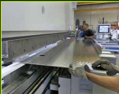
Abkantpresse 1.000 t Presskraft, bis 8 m Länge
